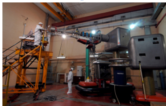
Generatore di neutroni di Frascati (ENEA, Frascati) P= 300 W spettro monocromatico 2.5 DD o 14 MeV DT
