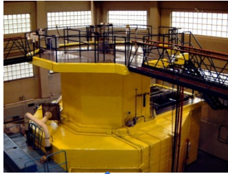
Reattore LENA-TRIGA (Università degli Studi di Pavia) P= 250 kW, spettro termico
