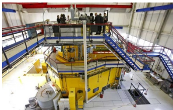
Reattore CASACCIA-TRIGA (ENEA Casaccia) P=1 MW Spettro termico
