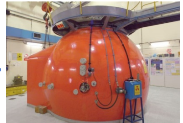
Reattore TAPIRO (ENEA Casaccia) P=5 kW Spettro di fissione non moderato
